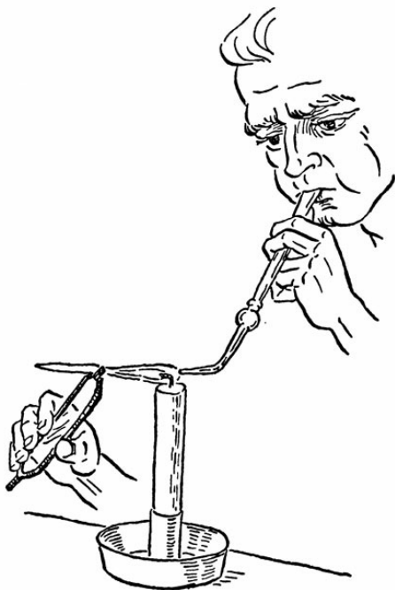
Fig. 6. El soplete, introducido en el laboratorio por el químico sueco Constedt (1722-1765), fue un instrumento clave de análisis durante
